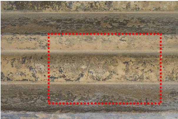
Εικόνα 1 Φάτνωμα 1Δ βόρεια, 1ο κυμάτιο. Με από το οποίο αποκτήθηκαν υπέρυθρες εικόνες, XRF φάσματα αλλά και σήματα αντηχήσεων (a-scans) με το ακουστικό μικροσκόπιο (βλ. παρακάτω).
