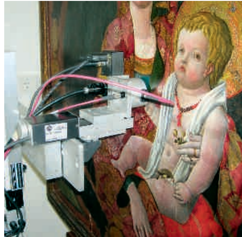
Το όργανο του φορητού εργαστηρίου του «Διαγνωστικού Κέντρου Έργων Τέχνης» του Ιδρύματος Ορμύλια, λαμβάνει in situ πληροφορία ανάκλασης από έργο του Τζιόρτζιο Τσιαβόνε στο Αμστερνταμ.
